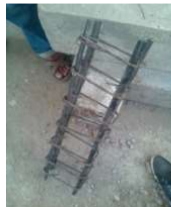
Fig No. 3 : bamboo cage
