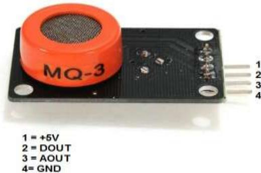
Fig: Alcohol Sensor
