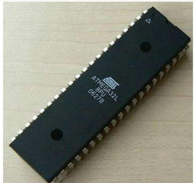
Figure 2 : Micro-controller: AVR At mega32
