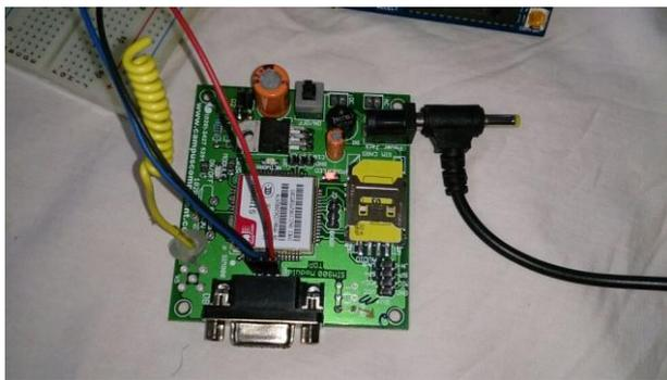
FIG 4: GSM SIM 900 Module.
