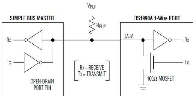
Figure 14. Equivalent circuit of ARM and DS1990A
