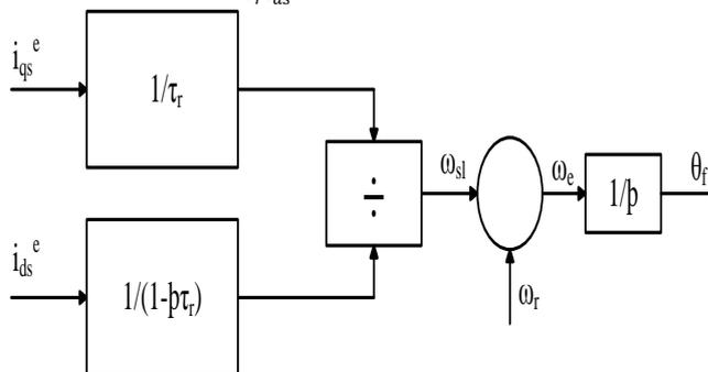
Fig. 4 Rotor Flux Estimator
