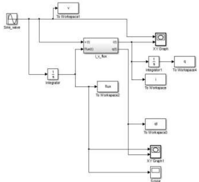
FIG. 7 SIMULINK MODEL OF HP MEMRISTOR
