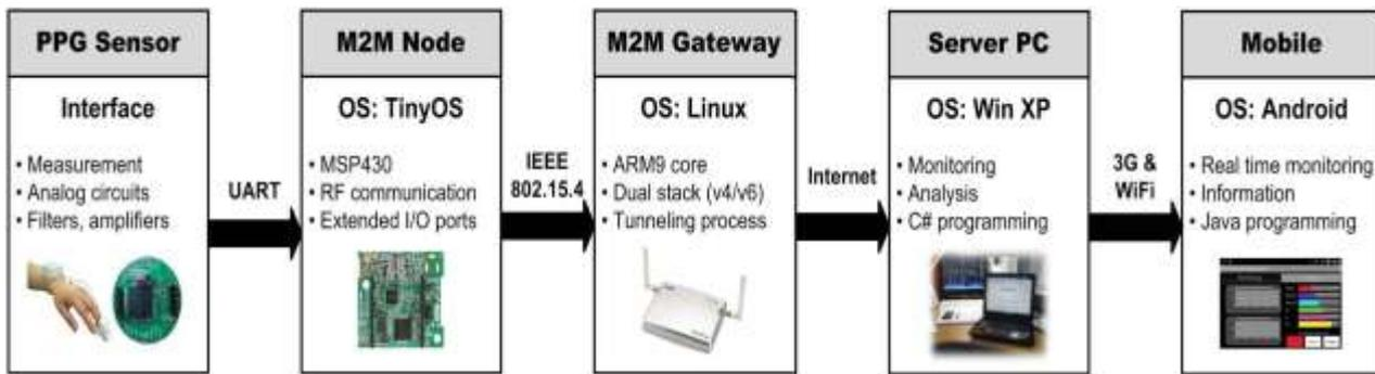
FIG.1 BLOCK DIAGRAM OF THE OVERALL SYSTEM ARCHITECTURE
