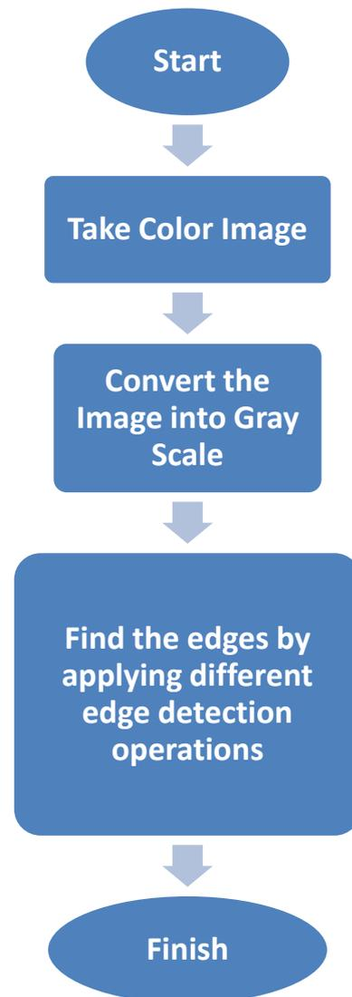
Fig. 2 Flow Chart of Edge Detection
