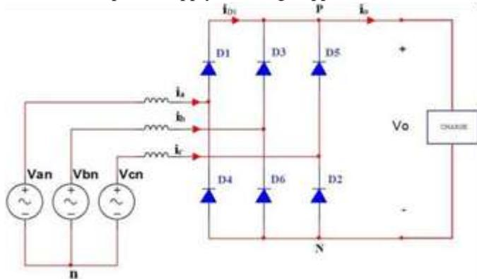
Fig. 4 Three phase rectifier
