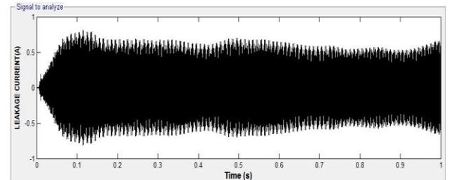
Fig.6 (d).H6 topology leakage current
