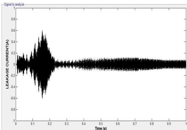
Fig.11 (d) Leakage current
